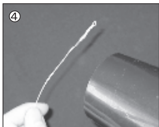
④～⑤ ドライヤーでチューブ全体を加熱し、収縮させます。 ※チューブが収縮しない場合は、さらにドライヤーを近づけて下さい。
